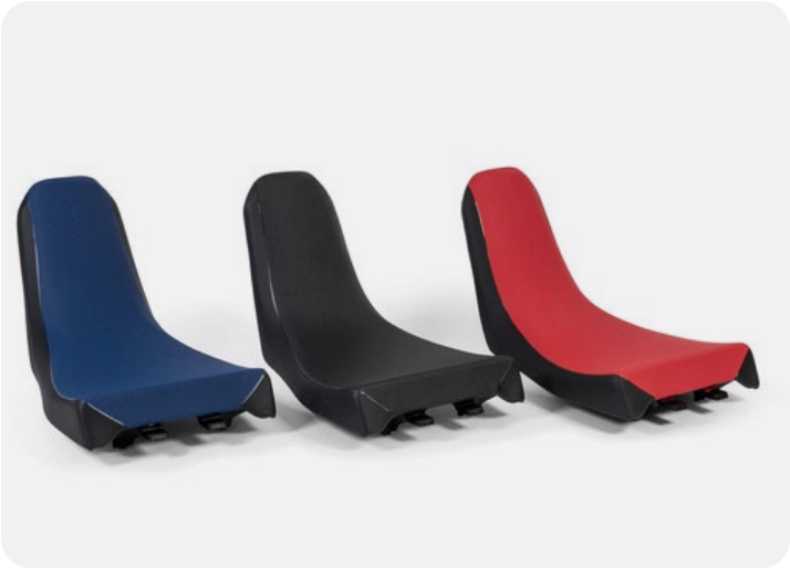
ALACSONYABB ÜLÉS 08R73-MKS-E00ZA / 08R73-MKS-E00ZB / 08R73-MKS-E00ZC Ez az ülés 25 mm-rel alacsonyabb üléspozíciót nyújt (a teljes ülés magasság 2 helyzetbe állítható: 795 vagy 815 mm-re az L4 változat és 825 vagy 845 mm-re az L1 és L3 változat esetén). 3 színben kapható: • 08R73-MKS-E00ZA - piros • 08R73-MKS-E00ZB - kék • 08R73-MKS-E00ZC - fekete
