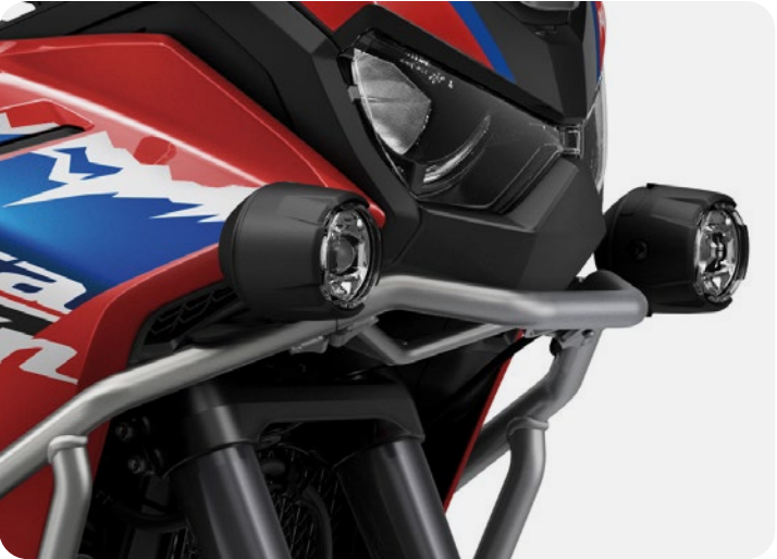
LED KÖDFÉNYSZÓRÓK 08ESY-MLN-FL Ez a 2 plusz LED fényoszóró jobb látási viszonyokat bi- tosít, és Ön is könnyebben észrevehető a közlekedés többi résztvevője számára. A LED ködfényszórók erős fehér fényükkel növelik a látási viszonyokat a rossz idő- járási körülmények esetén, energiafogyasztásuk pedig alacsony (11 W). A kormánykapcsolóról működtethe- tők, állapotuk pedig a TFT-képernyőn látható. Csak a bukócsővel együtt szerelhető fel (ezt a szett nem tartalmazza). A készlet a következőket tartalmazza: • LED ködfényszóró felszerelő készlet (08V70-MLN-E00) • LED ködfényszórók (08V73-MKS-E00)
