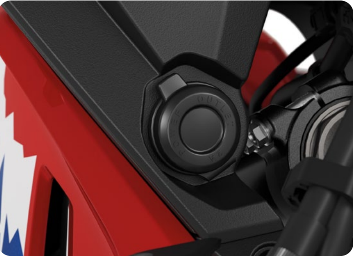
12 V CSATLAKOZÓ 08U70-MKS-E00 Ez a csatlakozó, amelyet a műszeregységre kell besze- relni, ideális az elektromos eszközök töltéséhez vagy tápellátásához.
