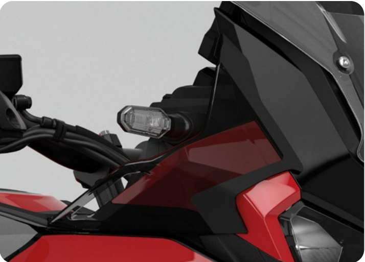
FELŐ LÉGTERELŐ 08R70-MLN-E00 A szél és időjárás elleni védelmet növeli a felső légtere- lő, melyek azáltal javítják a menetkomfortot, hogy csök- kentik a vezető karjai körül a légáramlást.
